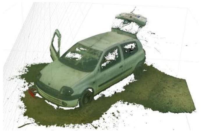
Figure 13 : Modélisation 3D d'un véhicule immergé en lac. Les surfaces vitrées ne sont pas modélisées ou présentent d'importantes aberrations.
